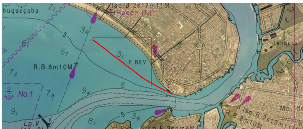
Figura 61 – Enrocamento Rochoso na Ponta da Praia (segmento em vermelho)
