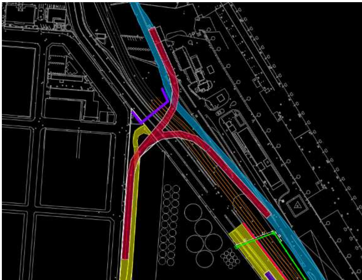
Figura 11 - Viaduto de acesso Concais/Marinha "Y" (em vermelho)
